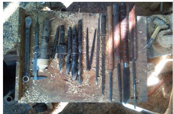
圖53 木工車床使用的各式刀具
