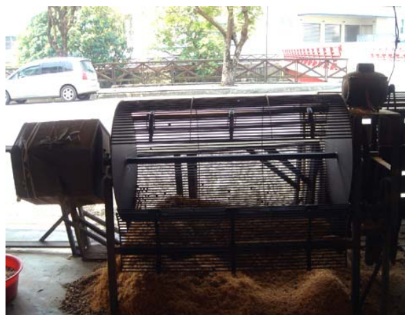
圖65步驟四將車枳產品及木屑放入滾筒機
