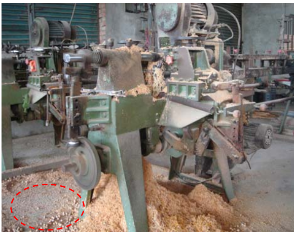
圖64步驟三經高速車床機研製成圓形車枳產品
