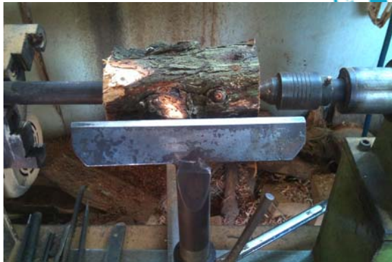
圖54步驟一先將木料固定在機座上
