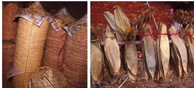
圖 58 以竹片完成內胎，再以麻竹葉或月桃葉一片片編成，即便採複合式素材製作，仍舊在同一體系循環下
